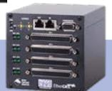
搭配專為當作 EtherCAT 從屬站針對 RT 應用設計的特殊 CPU 模組，使用 EtherCAT (確定性乙太網路)。EtherCAT 主控站/主機透過 CAT5e/6/7 系列纜線與 DNA-ECAT 通訊。多機箱連接不需要乙太網路交換機/路由器。其他主要規格包括內建看門狗計時器、安全狀態預設條件、以及纜線備援。提供無與倫比的通道密度(即每立方英尺的 I/O 通道)。
